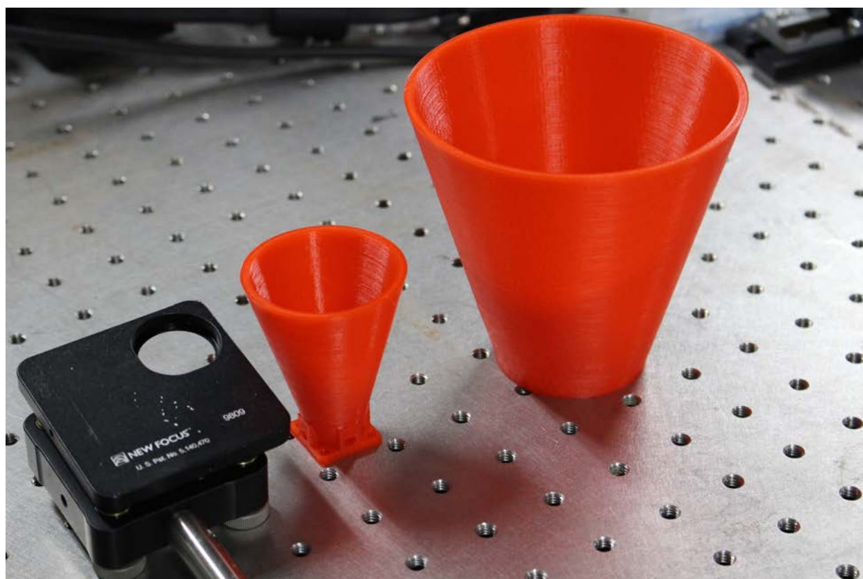
図 1.5.2: 2 つの部品に分けて出力したホーンアンテナ。表面に積層痕が残っている。
