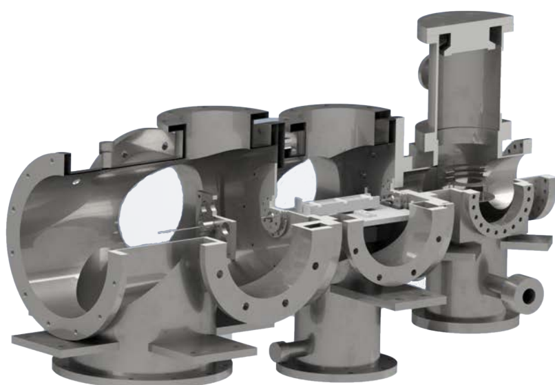
図 2.3.1: 本実験で利用した実験装置の 3DCAD イメージ図。本研究では 3 部屋のチャンパーを利用して実験を行った。アンモニア分子は左の部屋において、穴径 1 mm のパルスバルブから放出される。スキマーを通過した分子は 2 部屋目に侵入し、偏向器中を通過する。その後スキマーを通過して観測用のチャンパーへと至る。
