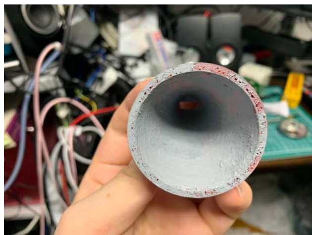
図 1.5.3: パテを利用して凹部分を埋めたあとの様子
