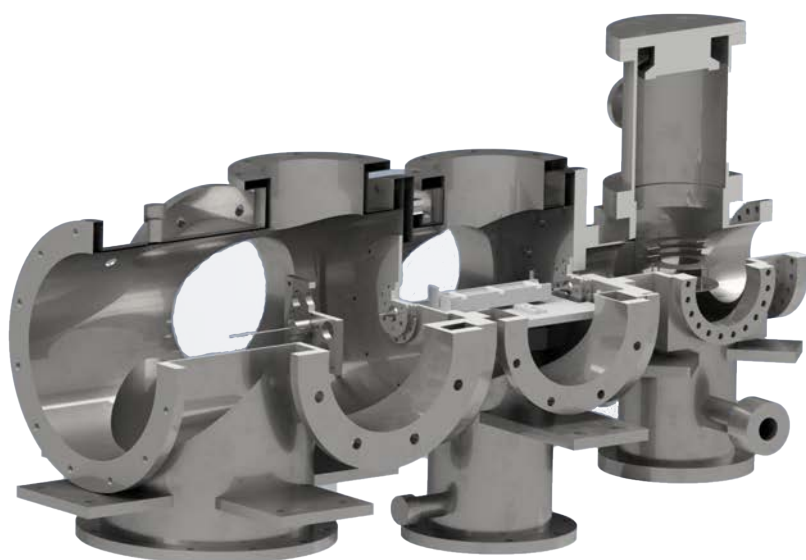
図 2.3.1: 本実験で利用した実験装置の 3DCAD イメージ図。本研究では 3 部屋のチャンバーを利用して実験を行った。アンモニア分子は左の部屋において、穴径 1 mm のパルスバルブから放出される。スキマーを通過した分子は 2 部屋目に侵入し、偏向器中を通過する。その後スキマーを通過して観測用のチャンバーへと至る。
