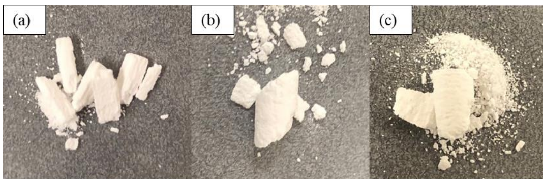
Figure 3-24 各方向に作製した処理後焼結体の破壊モード (72: 08: 20_0.350/0.350_AC(180°C, 24 h)+sintered) ; (a) x 方向、(b) y 方向、(c) z 方向
