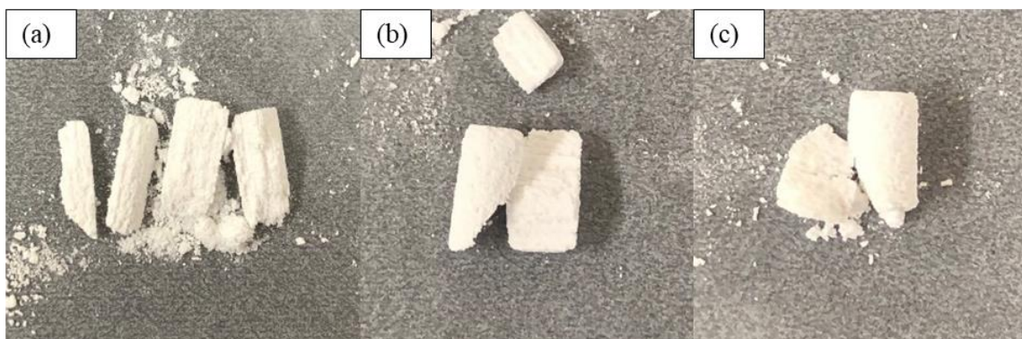
Figure 3-17 各方向に作製した造形物の破壊モード (72: 08: 20_0.350/0.350) ; (a) x 方向、(b) y 方向、(c) z 方向
