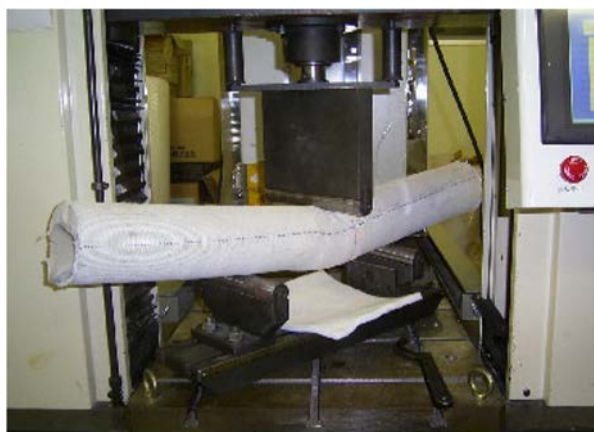
図 3.4.3.2 ジオジャケットの曲げ試験の状況 14)
