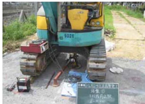
写真 3.3.2.3 平板載荷試験 (JIS A 1215)
