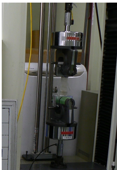
図 5.2.2.6 ジオテキスタイルの引張試験 (JIS L 1908) 状況
