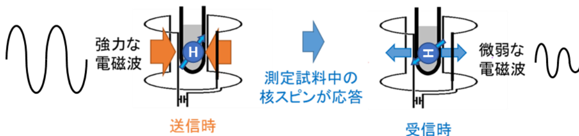
図 1.12 NMR プローブの仕組み
