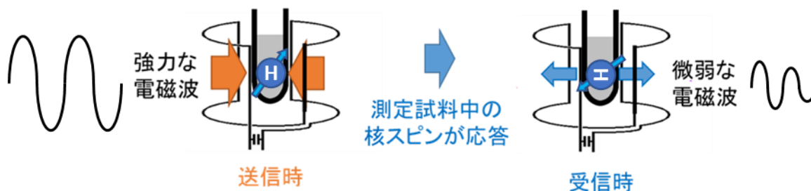
図 1.12 NMR プローブの仕組み
