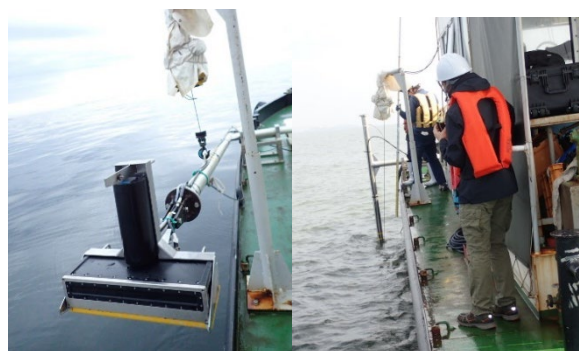
図-1.1.1 マルチビーム機器（左写真）とマルチビーム測深時の様子（右写真）
