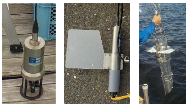
図-4.1.6 多項目水質計（左）、電磁流速計（中央）、コアサンプラー（右）
