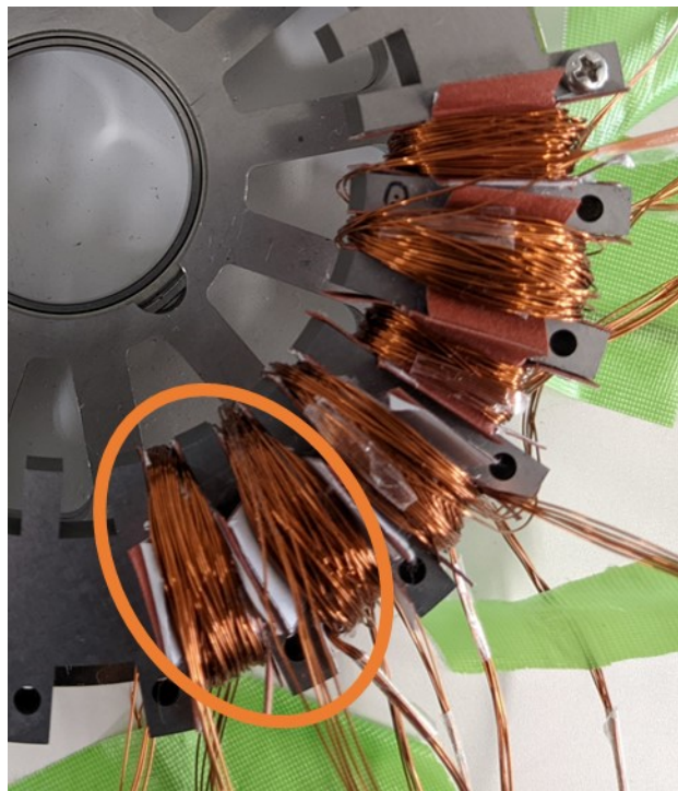
図 5.11. 巻線設計変更後の巻線
