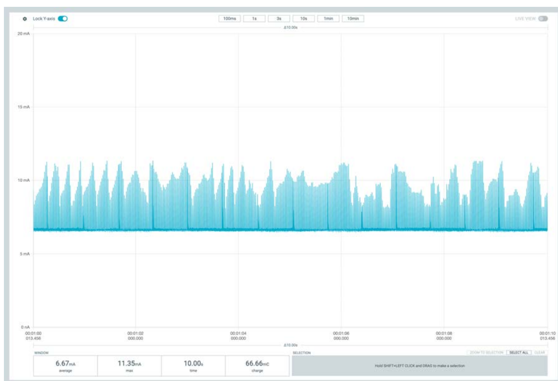
図 5.14 BlinkLEDモジュール (EvEmfrp, SLEEP, 負荷なし) の消費電流
