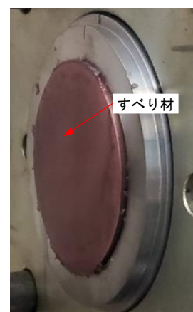
図 2 すべり材実験 試験体詳細
