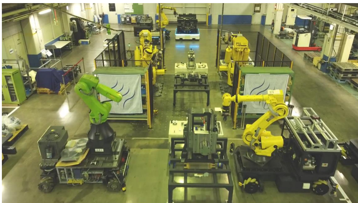
図 3. 44 工作機械の再構成可能な組立生産システムの実証実験
