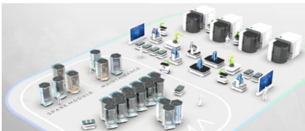
図2. 8 自律自走式ロボットセル群で構成される再構成可能な加工システム
