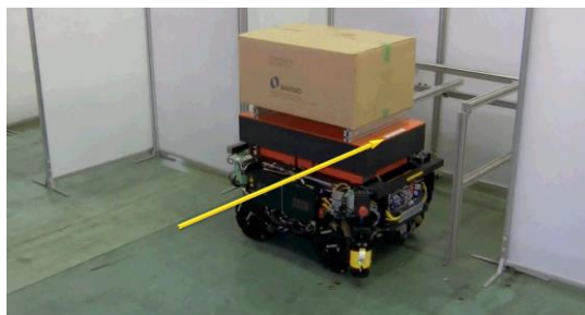
図 3. 25 Lifter による荷物自動運搬
