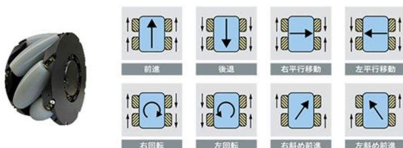
図 3. 4 メカナムホイールによる全方向走行
