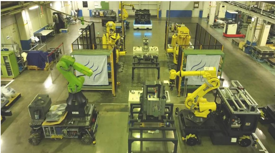
図 3. 44 工作機械の再構成可能な組立生産システムの実証実験
