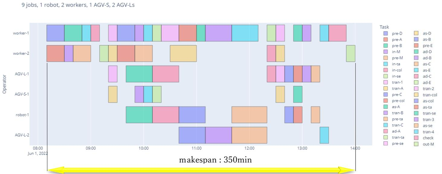
図 4. 1 0 LHS(N=38)による工作機械組み立てラインのスケジューリング：350 分
