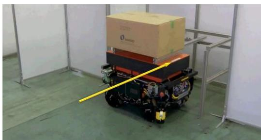
図 3. 25 Lifter による荷物自動運搬
