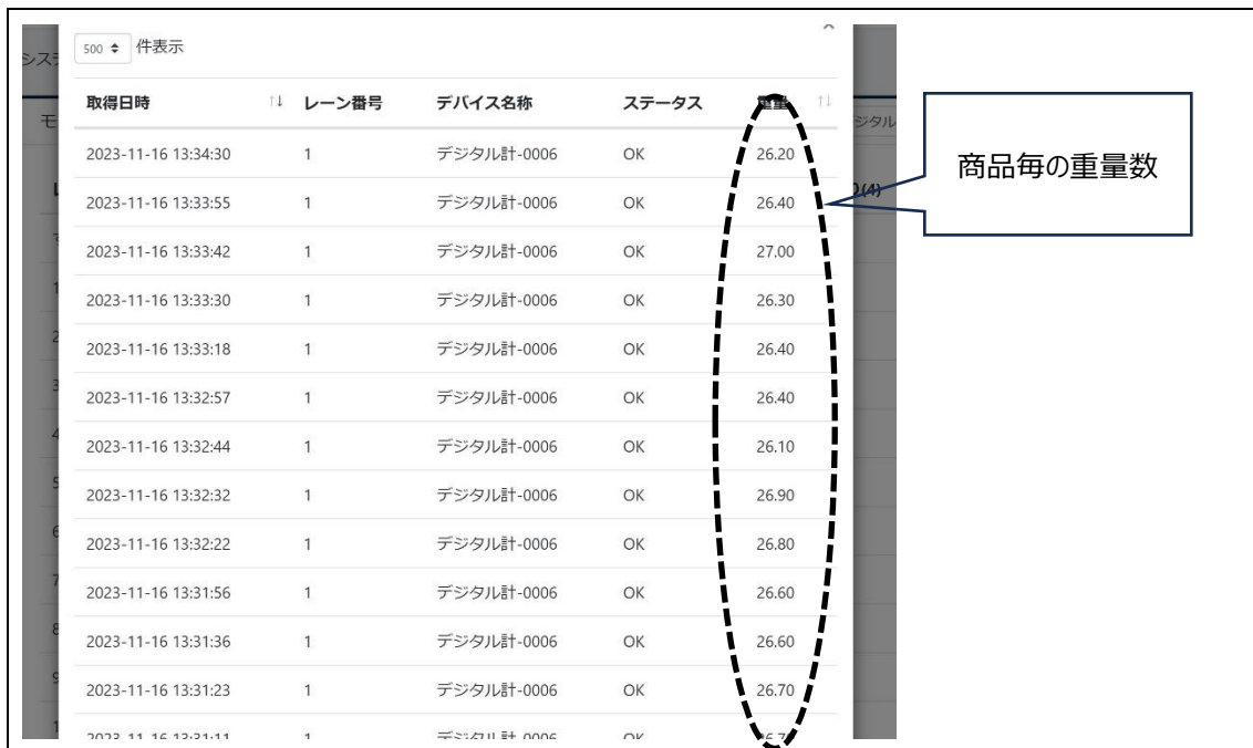
図 6-2 対象工場 B での IoT による商品毎での重量数の見える化
