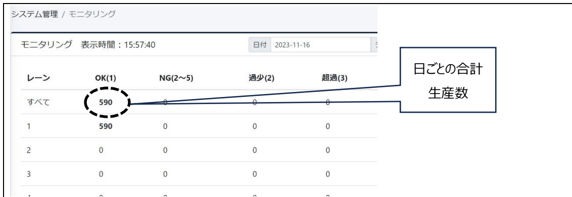
図 6-1 対象工場 B での IoT による生産進捗の見える化
