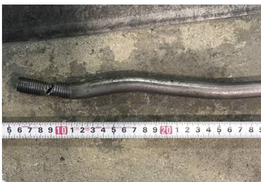
写真 2.5 4S16B120YN 芯材丸鋼の座屈
