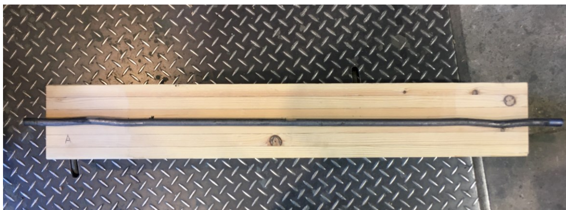
写真 2.7 4T16B160YY 芯材丸鋼の高次座屈（全体）
