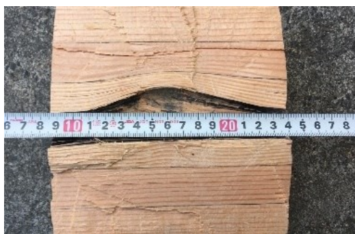
写真 2.3 芯材丸鋼の高次座屈長さ l_k の計測
