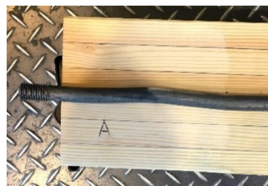
写真 2.6 4T16B160YY 芯材丸鋼の座屈
