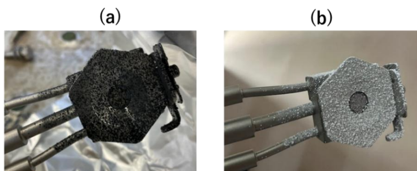
図 5.13 使用後の膜厚計(a)取り出し直後(b)数日後の状態
