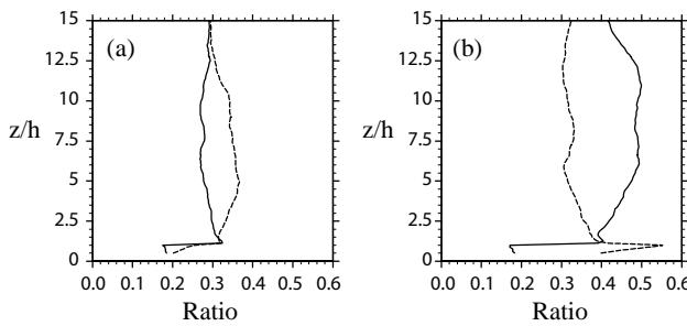
図-2 (a) Q2, Q4の発生率, (b) 運動量輸送への貢献度
