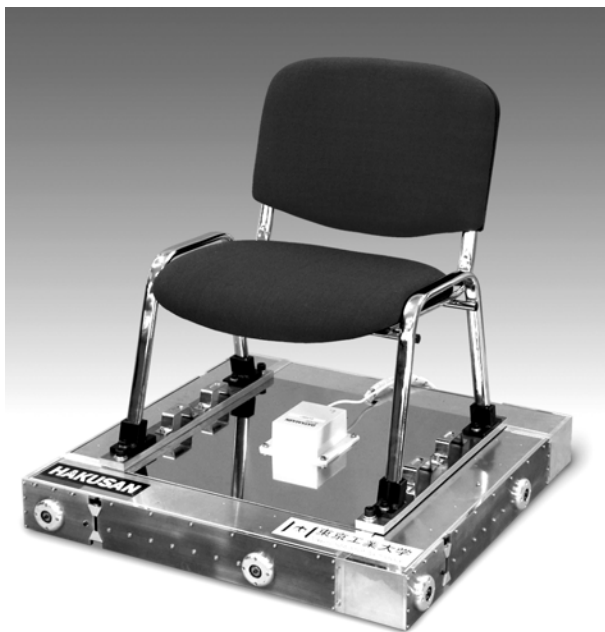
図5. 地震ザブトン試作機
