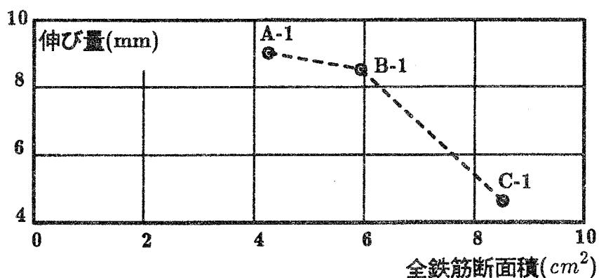
図2.23 全鉄筋の断面積 - 軸方向変形関係（図2.17中③）
