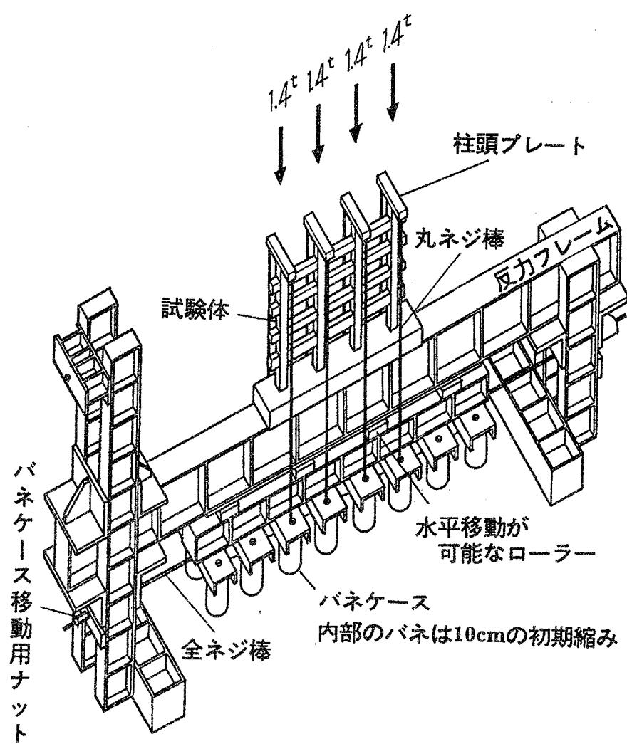
図4.3 加力装置(軸力導入に関する説明図)
