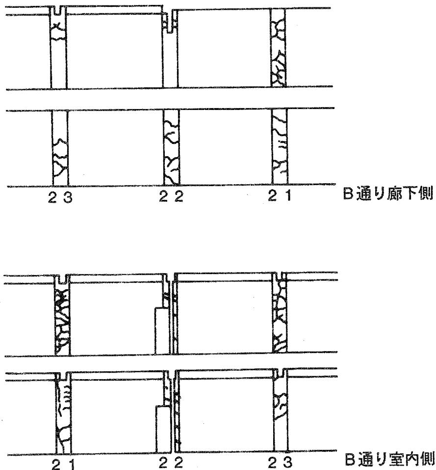
図a2.9 ひび割れ図(B通り21～23柱近辺、文献54より転写)
