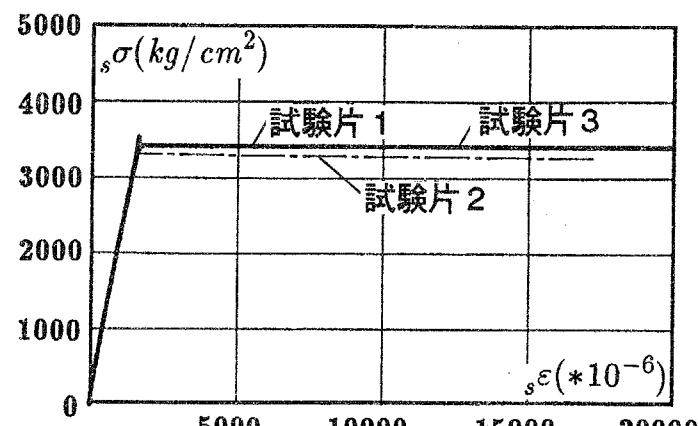
図4.6 D 3 鉄筋の応力－ひずみ関係
