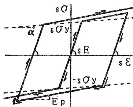
図a1.4 鉄筋の応力-ひずみ関係
