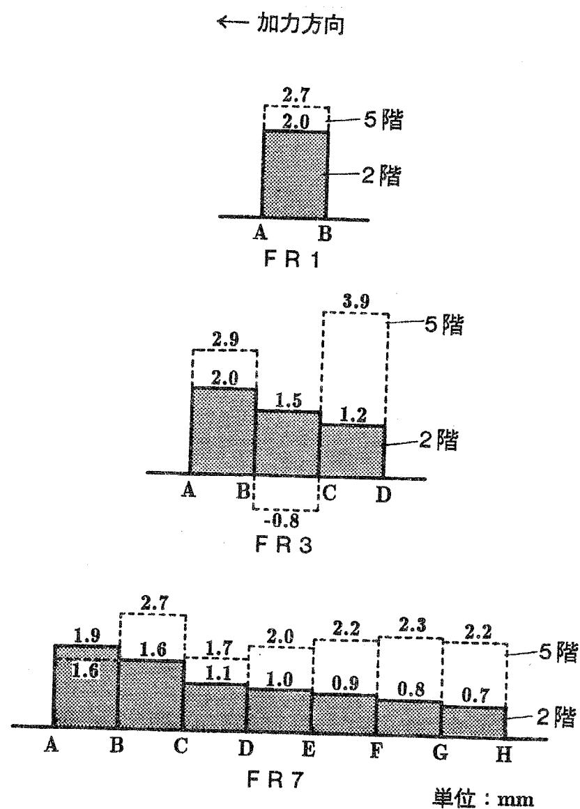
図4.20 全体変形角が $1/20$ のときのはりの軸方向変位
