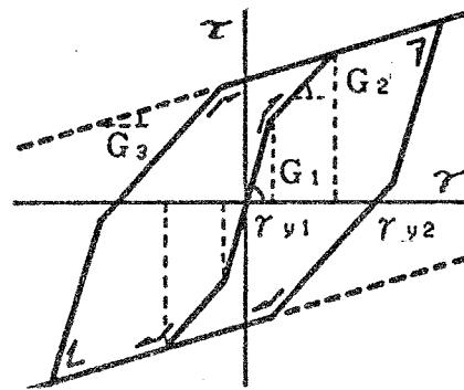
図a1.6 接合部パネルの応力-ひずみ関係
