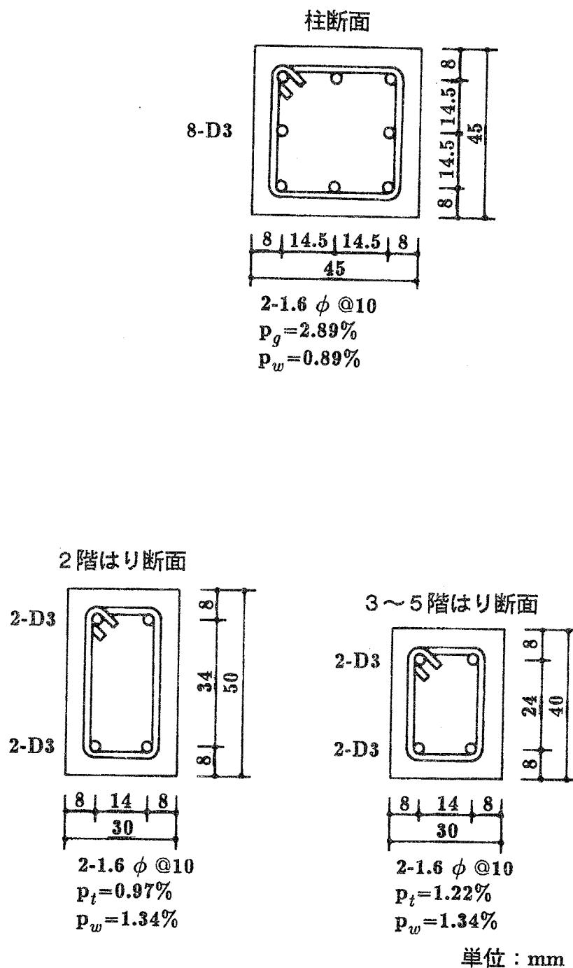
図4.1 試験体断面
