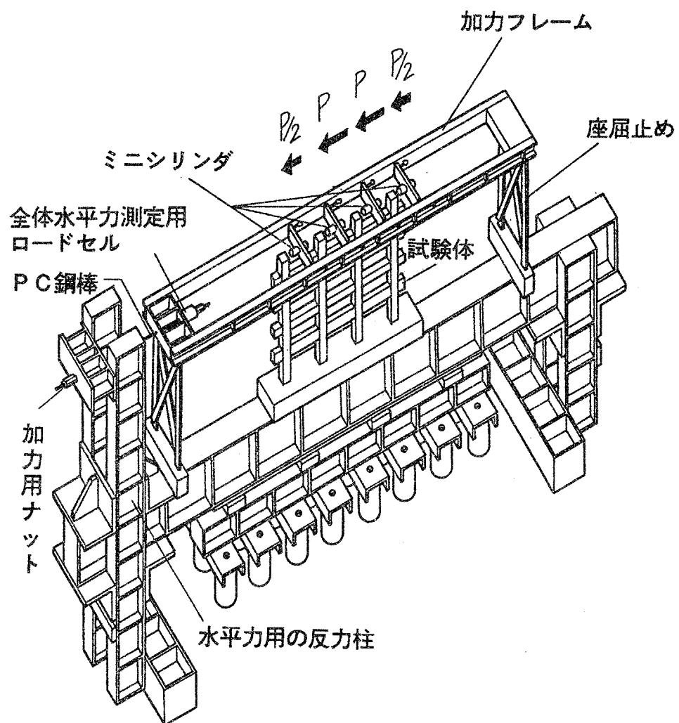
図4.4 加力装置(水平力導入に関する説明図)
