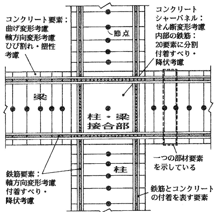
図a1.1 鉄筋コンクリート骨組モデル
