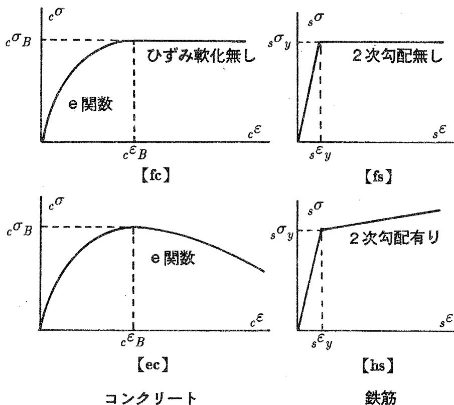
図5.4 コンクリートおよび鉄筋の応力-ひずみ関係
