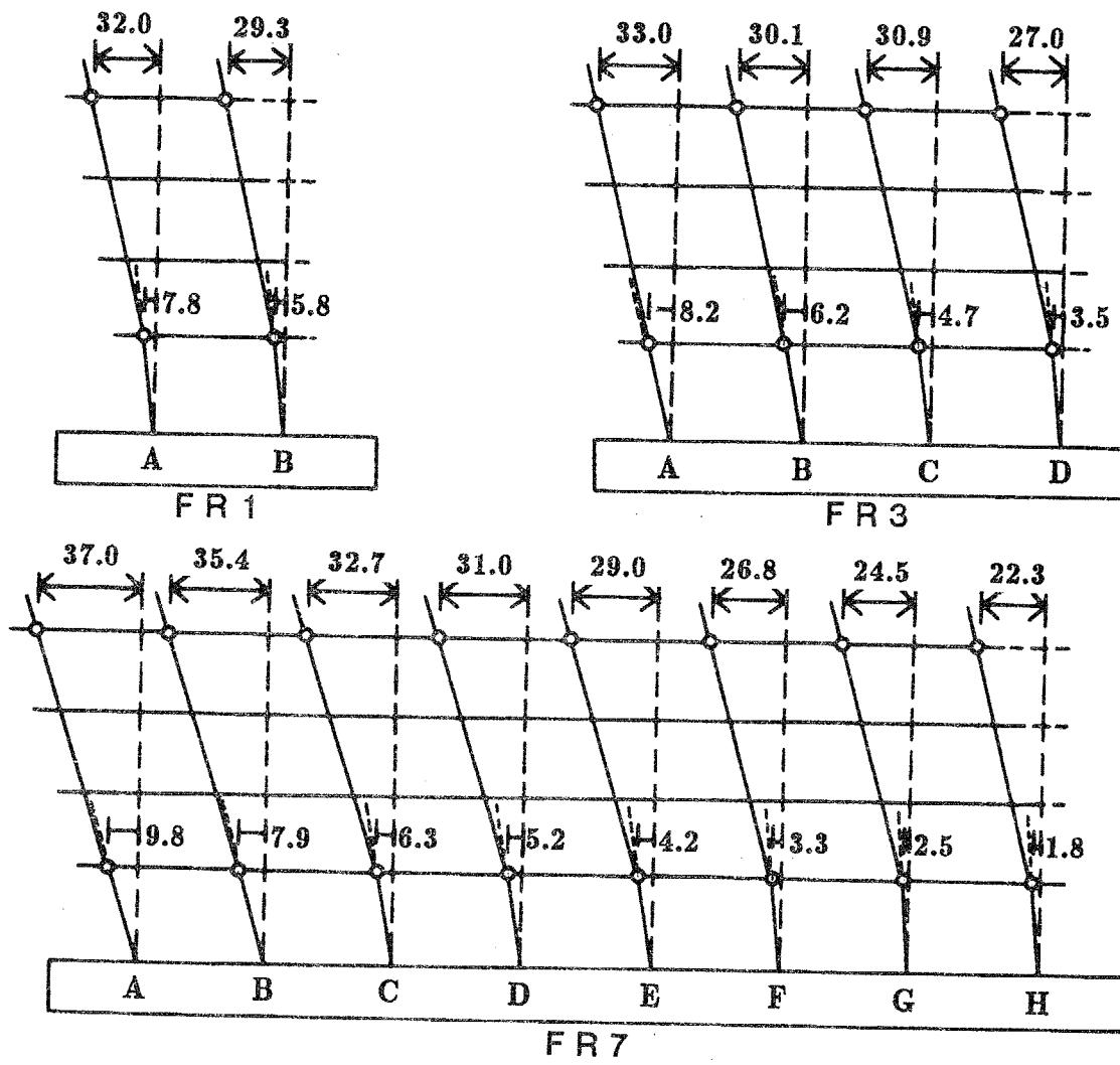
図4.24 全体変形角1/20における変形状態
