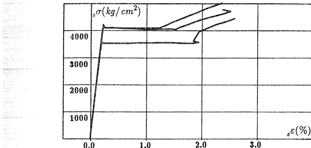
図2.11 Cシリーズに使用した鉄筋D10の応力-ひずみ関係
