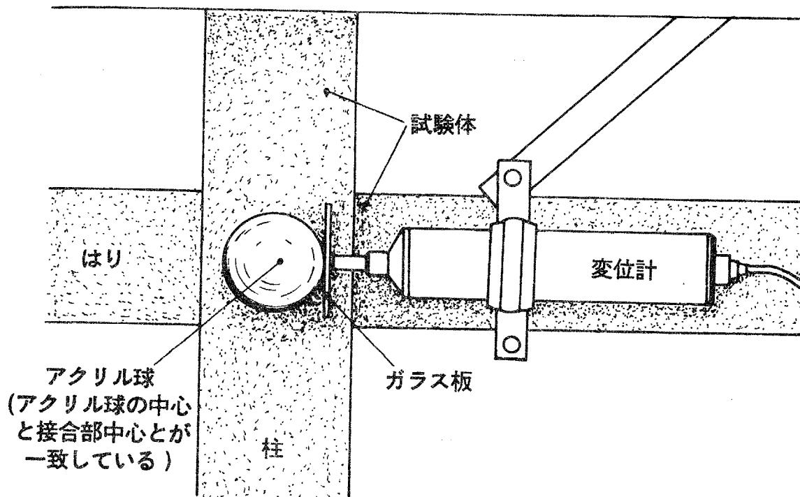
図4.10 水平変位測定点の詳細
