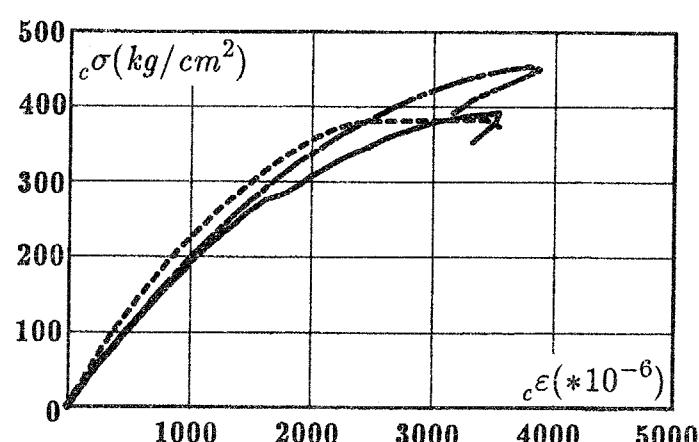
図4.7 モルタルの応力－ひずみ関係(40日)
