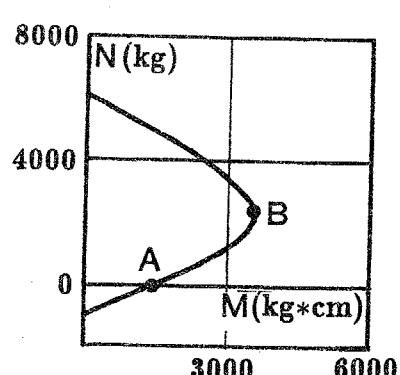
図4.11 各部材断面のN-M相關曲線
