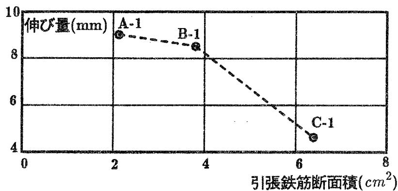
図2.22 引張鉄筋の断面積 - 軸方向変形関係（図2.17中②）
