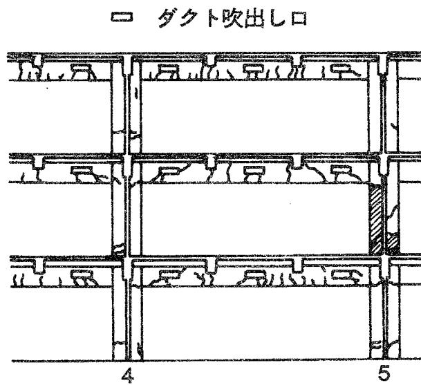
図a2.2 ひび割れ図(B通り5柱近辺, 文献53より転写)
