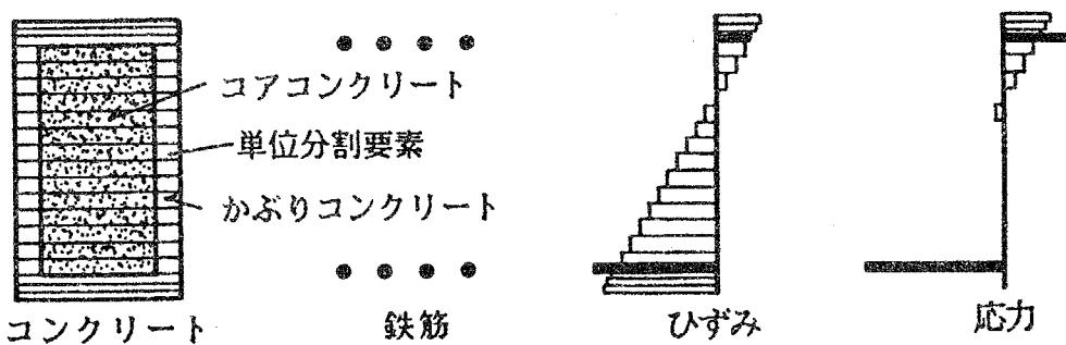
図a1.2 部材要素断面の分割とひずみ・応力
