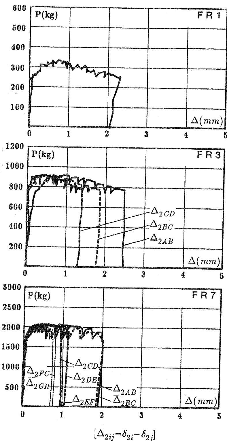
図4.19 水平力 – 2階はりの軸方向変位関係
