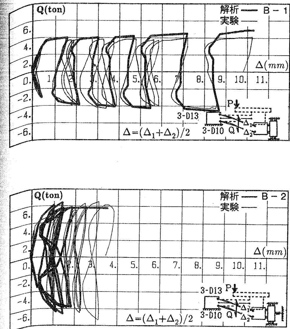
図3.6 せん断力-軸方向変形関係(Bシリーズ)
