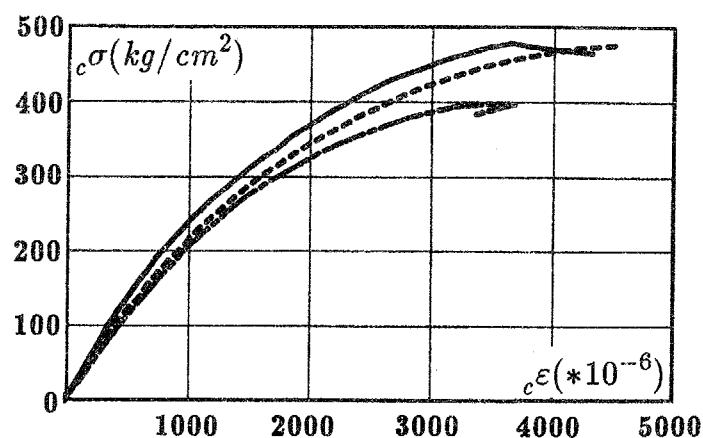
図4.8 モルタルの応力－ひずみ関係(56日)
