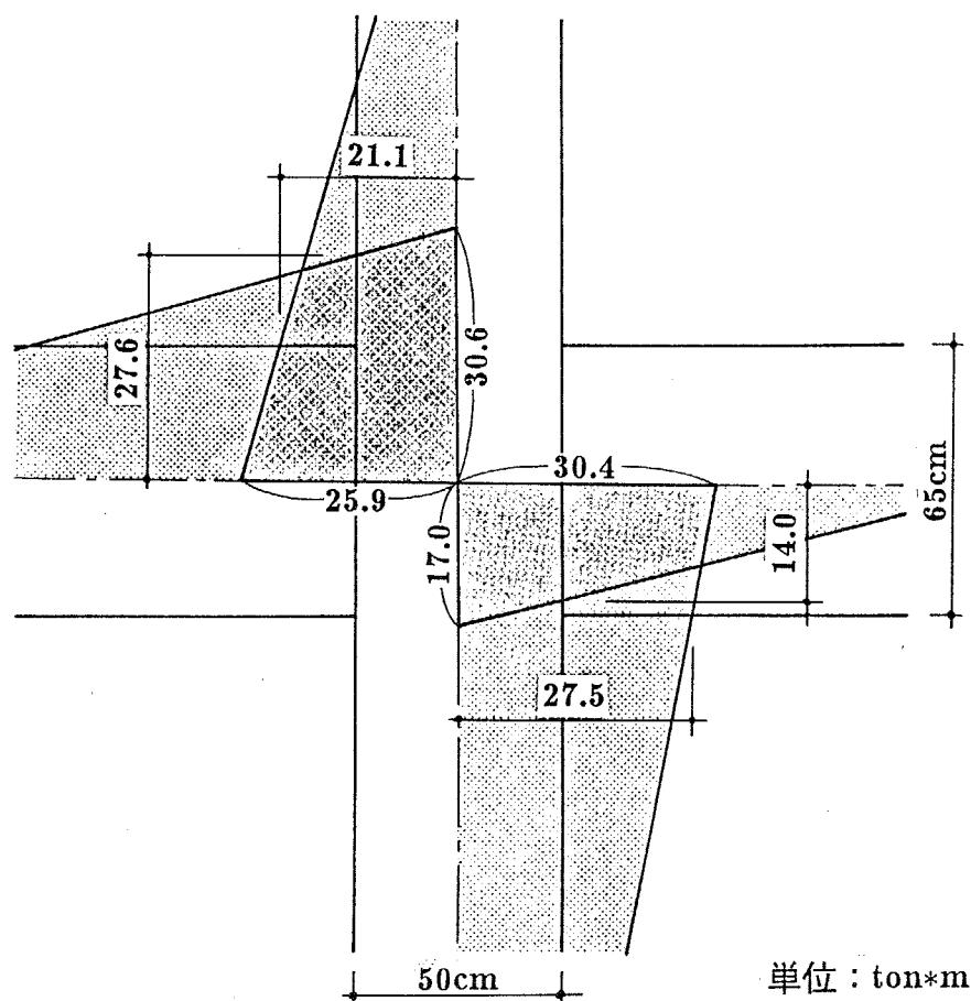
図a2.13 曲げ終局強度図(はりの軸力 = 0)
