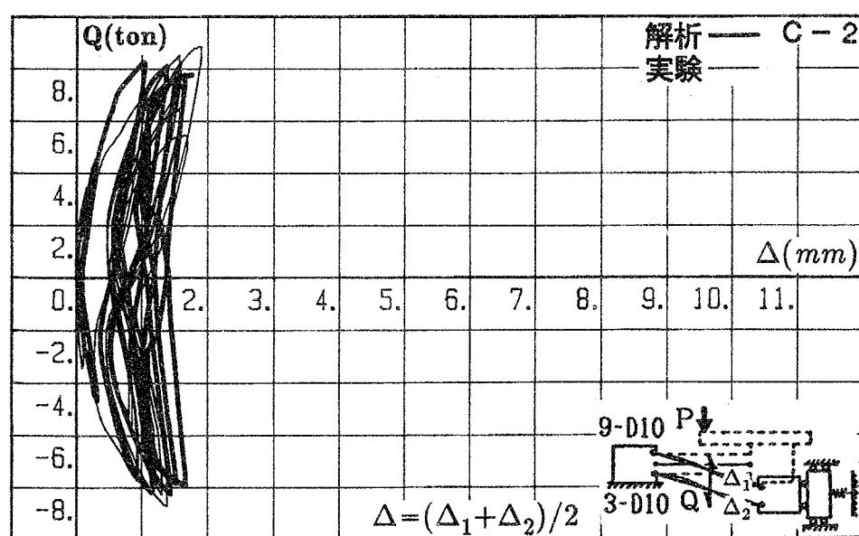
図3.7 せん断力-軸方向変形関係(Cシリーズ)
