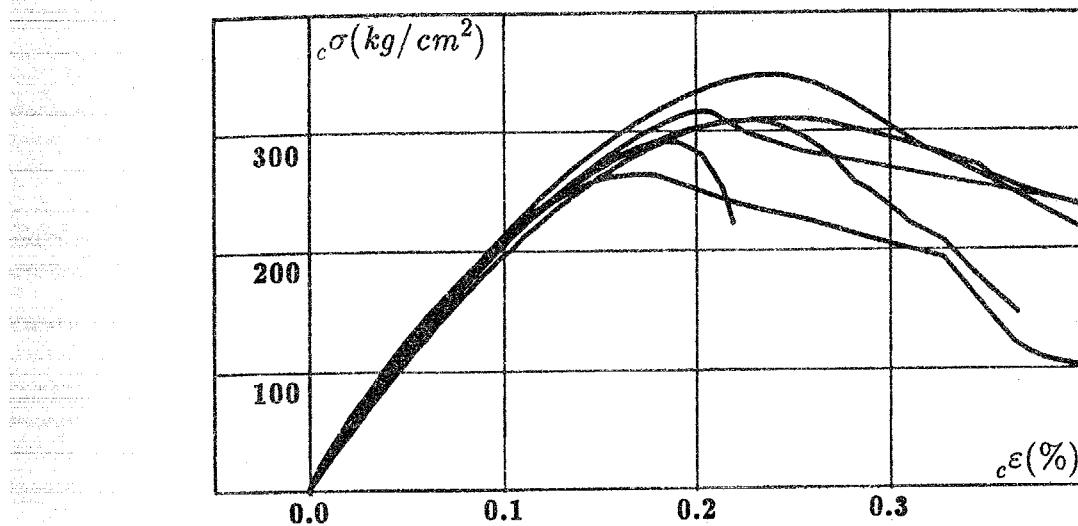
図2.8 A, Bシリーズに使用したコンクリートの応力-ひずみ関係（材令40日）
