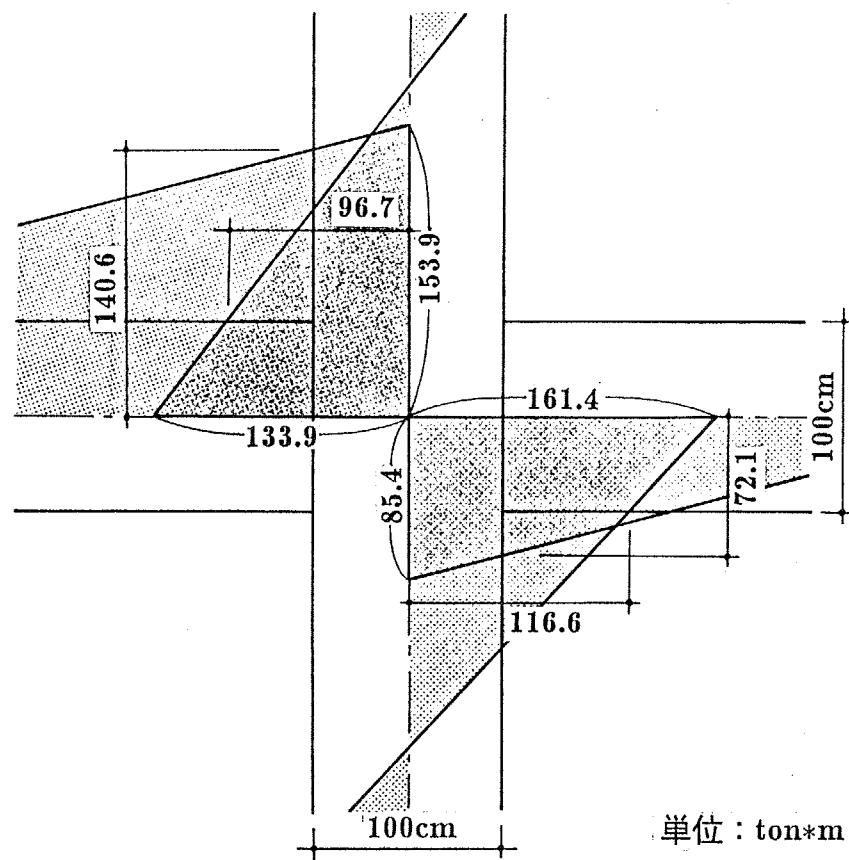
図a2.6 曲げ終局強度図(はりの軸力=0)
