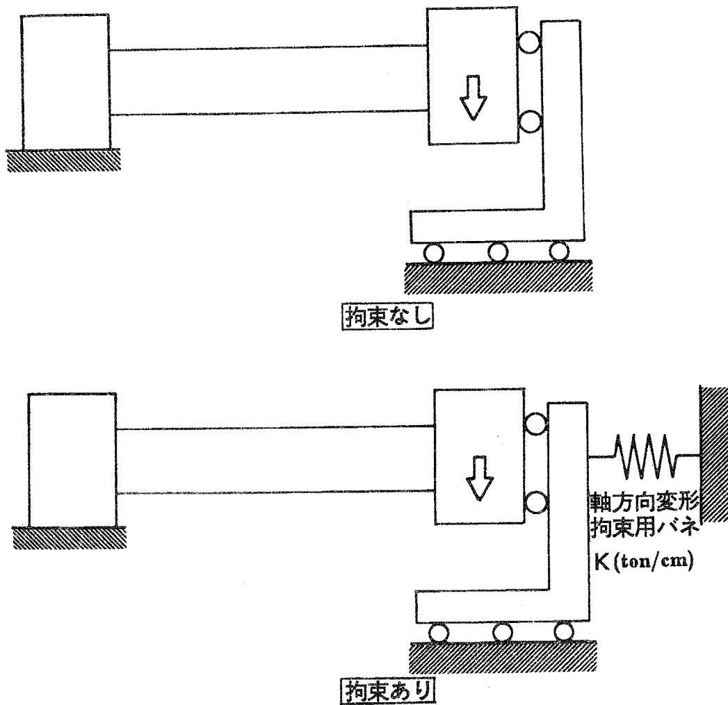
図2.1 本実験の概念図
