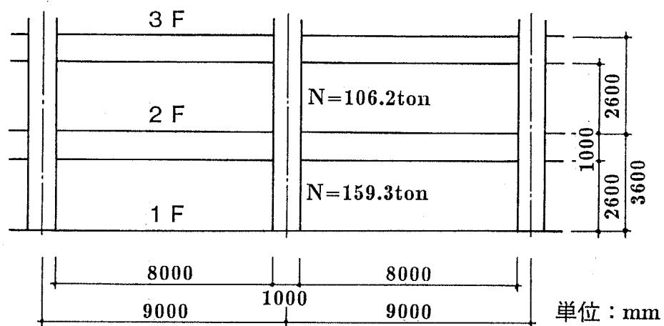
図a2.5 注目している構面の立面図
