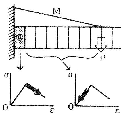
図a1.7 ひずみ軟化特性を有する材料
