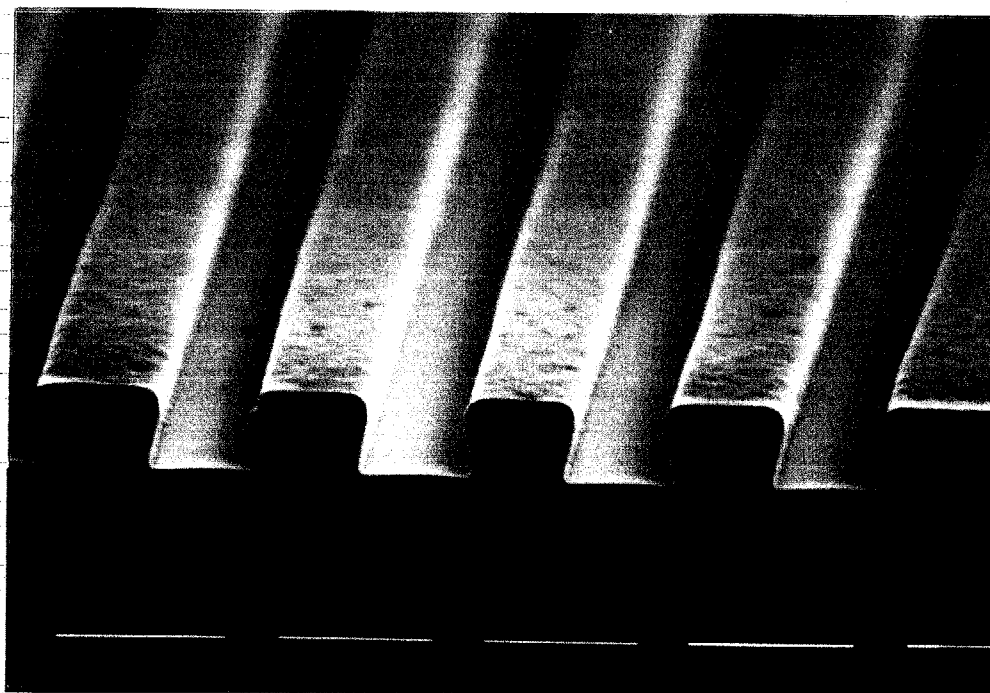
図3-7 レジストマスクパターン。(マーカー長: 1\mu\text{m} )
