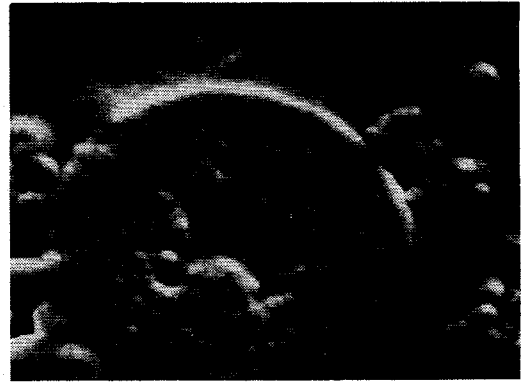
図3-6 合成温度の異なるSrTiO 3 微粒子断面のSEM写真 合成温度: (a) 500°C, (b) 1000°C
