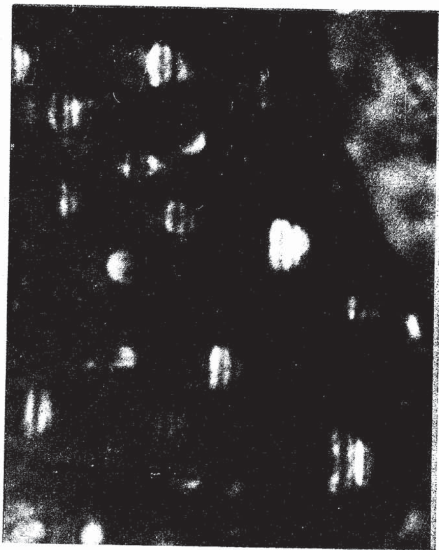
図4-16 図4-15 と比較しうる反射条件で撮った \text{Sn}/\text{SnTe} 膜の (400) 暗視野像. 粒子中に現われているモアレ縞のコントラストに, 交互の強弱変化が認められない。
