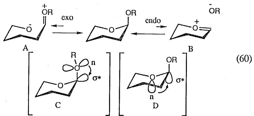
本研究の5-チオグルコース誘導体の求電子酸化反応においては1位置換基の誘起効果と共鳴効果の両者が立体選択性発現に関与していることが判明したが、電子吸引性誘起効果は式60のDに示した様なn- $\sigma^*$ 相互作用を、電子供与性共鳴効果は式60のCに示した様なn- $\sigma^*$ 相互作用を増大する可能性が示唆される。そこでこの可能性について検討するために、モデル化合物( $\text{CH}_3\text{SCH}_2\text{X}$ )に対する拡張ヒュッケル分子軌道計算<sup>159</sup>を行い、1位置換基の電子的性質とアノマー効果の関連について調べることにした。モデル化合物の幾可はメチル5-チオリボピラノシドのX線解析データ<sup>150</sup>を参照した(図-49)。計算は6種の置換基( $\text{X}=\text{CH}_3, \text{H}, \text{NH}_2, \text{OMe}, \text{OAc}, \text{F}$ )について行ったが、各種の出力結果のうちXによる違いが顯
