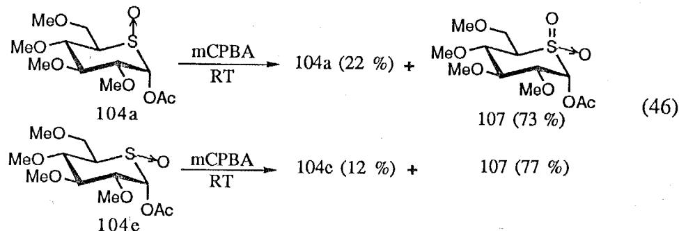
緒言で述べた4-*tert*-ブチルチアンのmCPBA酸化におけるエクアトリアル選択性についてJohnsonらは3,5位アキシアル水素原子とmCPBAの立体反発によるものと考えている<sup>128</sup>。しかし本研究で見いだされた立体選択性の逆転は、メトキシ基とアセトキシ基の嵩高さに起因するとは考えにくい。また、高い極性を持ちルイス塩基性が比較的高いアセトニトリルを溶媒に用いても立体選択性に顕著な変化が見られないことから、遷移状態におけるS-O結合とグリコシド結合との双極子-双極子相互作用<sup>147</sup>やmCPBAと基質が持つ酸素原子との間の水素結合<sup>148</sup>が関連するとは思えない。したがって、何らかの軌道相互作用が関連する可能性が強いが、これを検証するためには電子的性質が異なる種々の置換基を5-チオグルコースの1位に導入し、その立体選択性と電子的効果の関連を調べる必要がある。これについては第二節で検討を行う。
