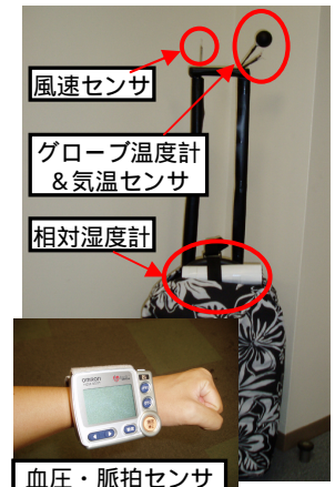
図-2 観測システム写真 気温センサは直達日射を受けないようにグローブ温度計の影に入るように調整．放射による気温計測誤差は最大でも0.1以下
