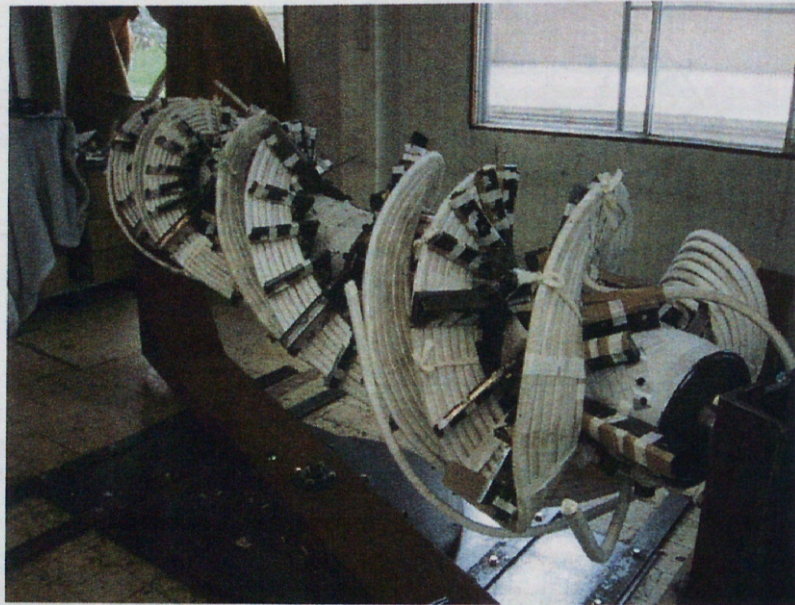
図 AP4-1:巻型に最も近い層のコイルの巻線終了時
