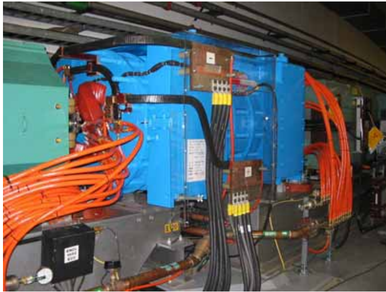
図 6-1-2 : AGS 加速器に設置された Warm Snake
