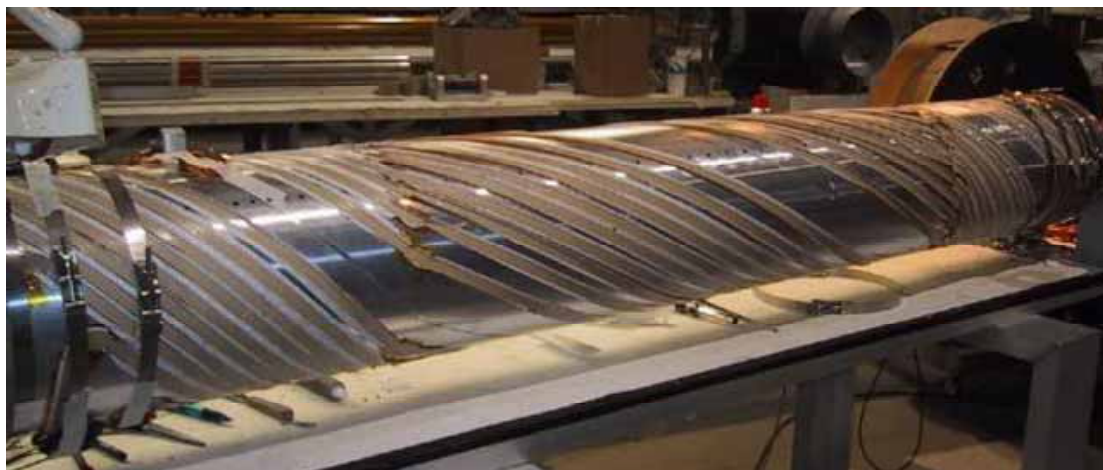
図 6-2-2 : 製作中の超伝導ヘリカルコイル
