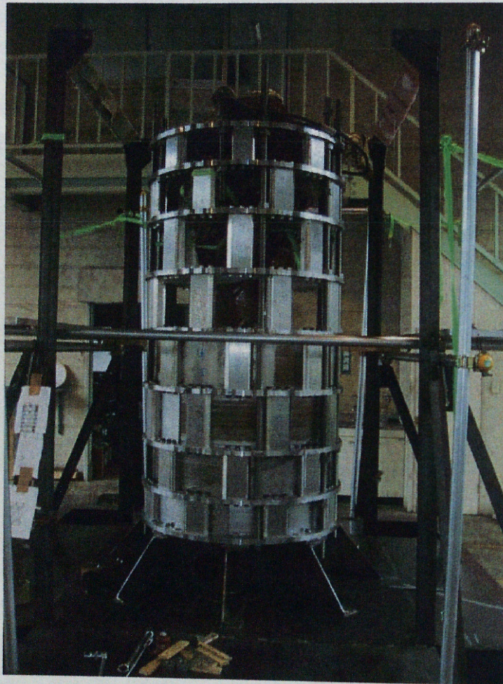
図 AP4-6: 半分の鉄芯が完成した後、上下逆さまにしたときの写真 図 AP4-3 のように電磁石中央から上半分のケイ素鋼板を積み上げた後、電磁石は上下逆さまにされ、残り半分の鉄芯を積み上げた。
