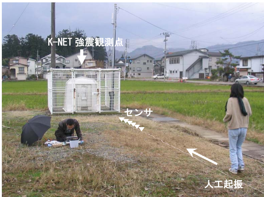
写真 4. 2. 2-1 強震観測点での表面波探査 (K-NET)
