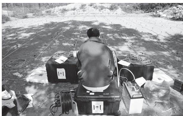
図-2 表面電位探査風景(2005年度調査)
