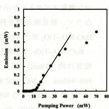
図 6 16000ppm-Nd<sup>3+</sup>添加テラス微小球の発振強度の励起光強度依存性
