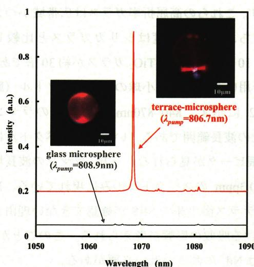
図 5 16000ppm-Nd<sup>3+</sup>添加ガラス微小球とテラス微小球の 1.06μm 帯における発振スペクトル
