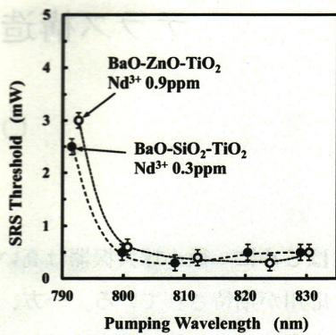
図 4 低濃度 Nd<sup>3+</sup>添加の BaO-SiO<sub>2</sub>-TiO<sub>2</sub> テラス微小球と BaO-ZnO-TiO<sub>2</sub> テラス微小球の SRS しきい値
