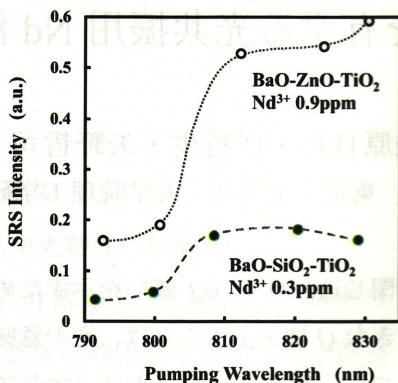
図 3 低濃度 Nd<sup>3+</sup>添加の BaO-SiO<sub>2</sub>-TiO<sub>2</sub> テラス微小球と BaO-ZnO-TiO<sub>2</sub> テラス微小球の SRS 強度
