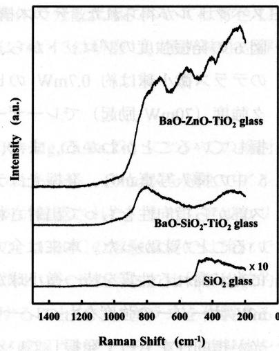
図 1 高屈折率ガラスとシリカガラスのラマン散乱スペクトル
