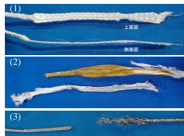
図5 破断の様子:左側でクランプ．(1) ダイニーマ (2) ザイロンダイニーマ (3) ステンレスワイヤ
