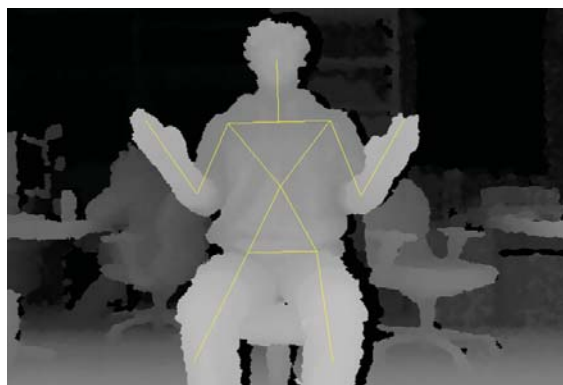
図 6 Kinect から得られる深度画像と骨格推定結果
