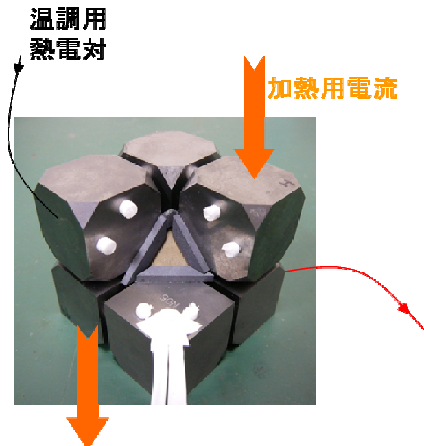
図 2-3. 川井式高圧合成装置の 2 段階アンビルの構成
