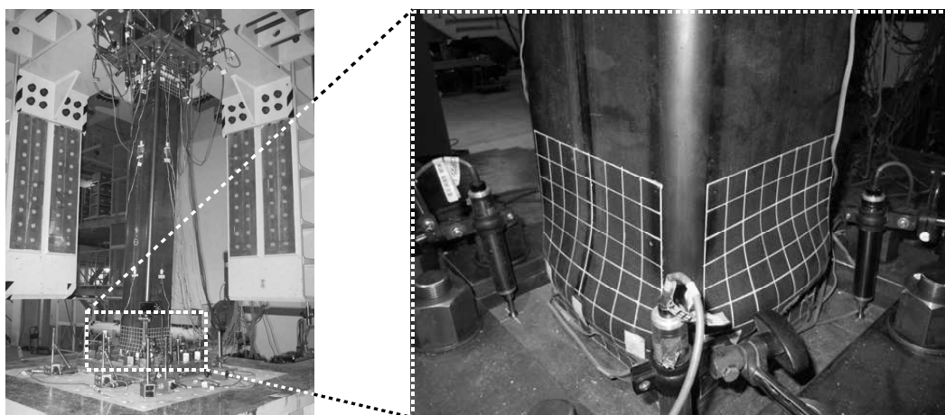
写真3.2 局部座屈の発生状況(CB00_0.2_22)
