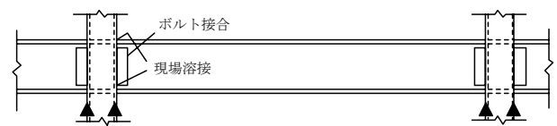
(b) 現場溶接接合
