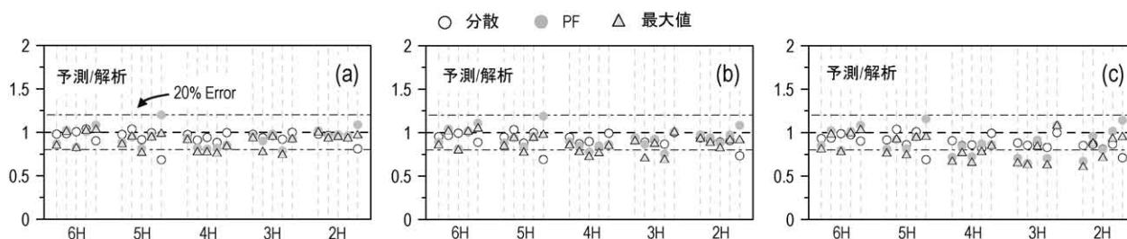
図 11 風直角方向の誤差評価:(a)変位、(b)速度、(c)加速度、(各モデルにおいて左から順にタイプ 1, 2, 3, 4, 5)
