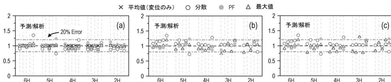
図 10 風方向の誤差評価:(a)変位、(b)速度、(c)加速度、(各モデルにおいて左から順にタイプ 1, 2, 3, 4, 5)
