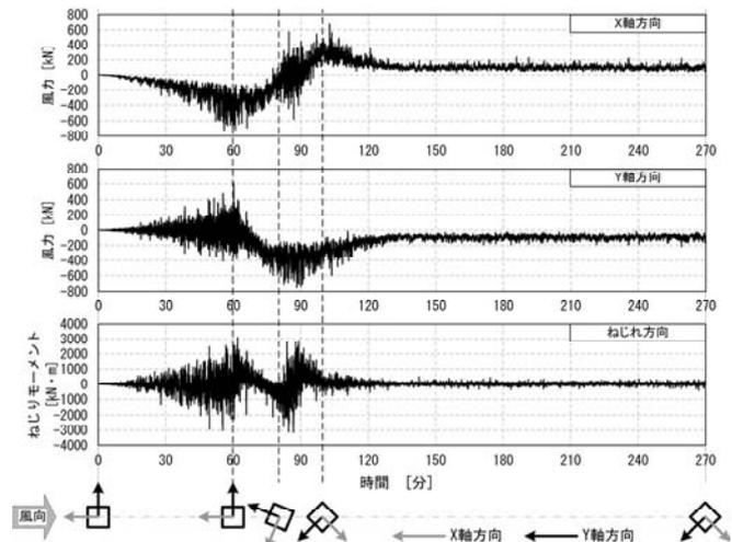
図 4 台風 200418 号モデル波形
