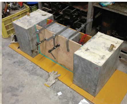
(d) Formwork for cast-in-place UFC
