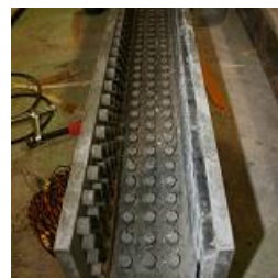
(a) 円柱突起の設置状況 (b) 円柱突起の寸法 図 6.14 UFC 表面に設置した円柱突起(UFC と充填したコンクリートの界面)
