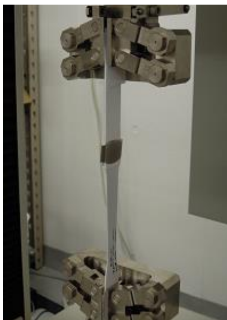
図 2-9 万能材料試験機を用いた接合試験片の引張せん断試験
