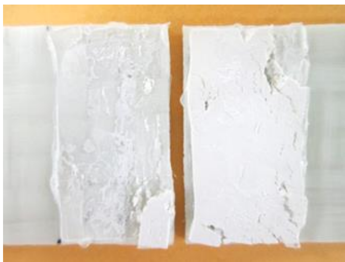
図 4-10 ZnO を 40 vol%含有した接着層を用いて高周波誘電加熱接合した (a)重ね合わせ接合試験片及び (b)引張せん断試験後の破断面写真
