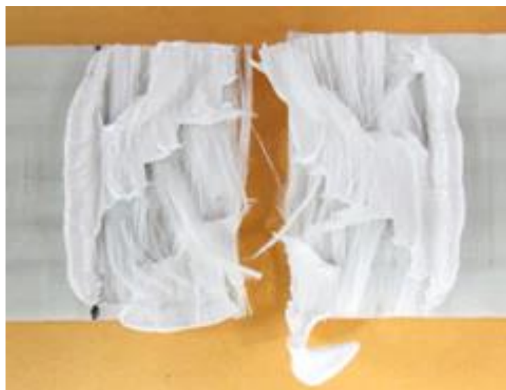
図 4-9 ZnO を 10 vol% 含有した接着層を用いて高周波誘電加熱接合した (a)重ね合わせ接合試験片及び (b)引張せん断試験後の破断面写真
