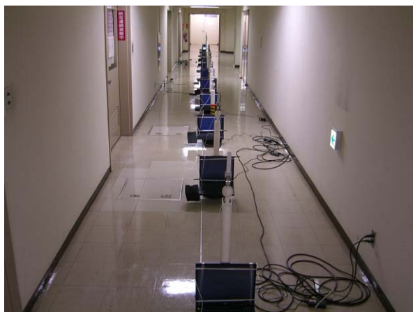
図4-2 中継区間が短距離の場合(屋内)の測定環境
