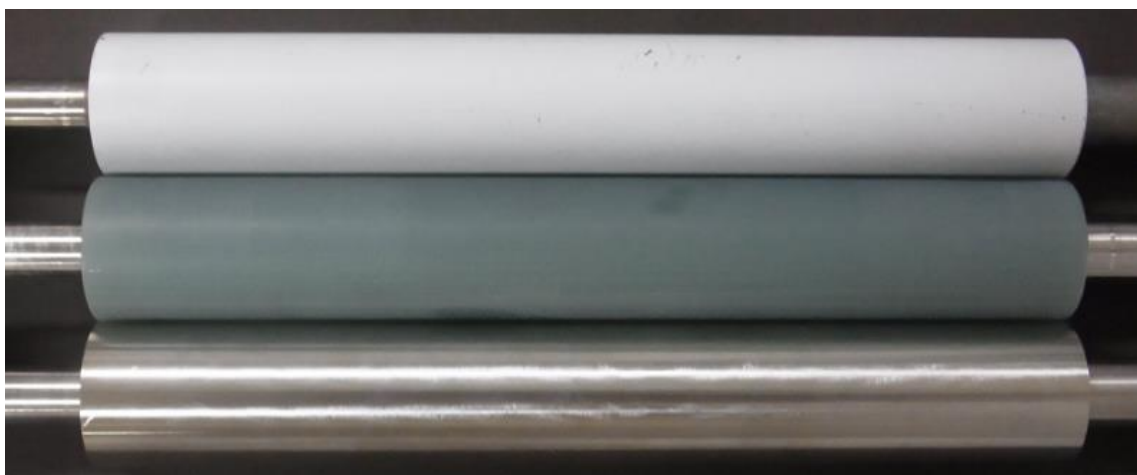
Figure 4-4 本研究で用いた濡れ性の異なる種々の回転内筒 (200 mm)
