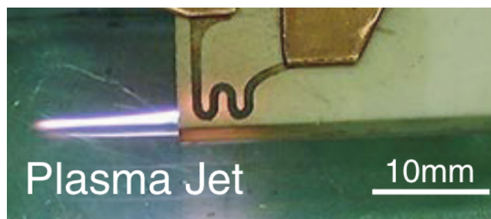
Figure 2.4 マイクロストリップ線路による誘導結合型のマイクロプラズマの例 [27]
