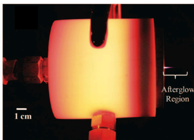
Figure 2.8 FAPA の概念図および放電の様子 [59]
