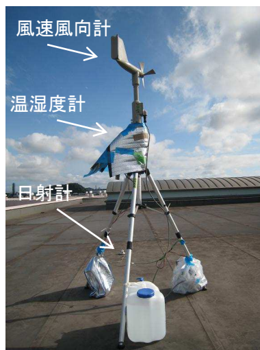
図 2-10 外部気象測定位置と測定機器
