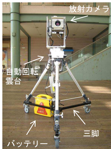
図 2-15 全球熱画像収録システムの外観
