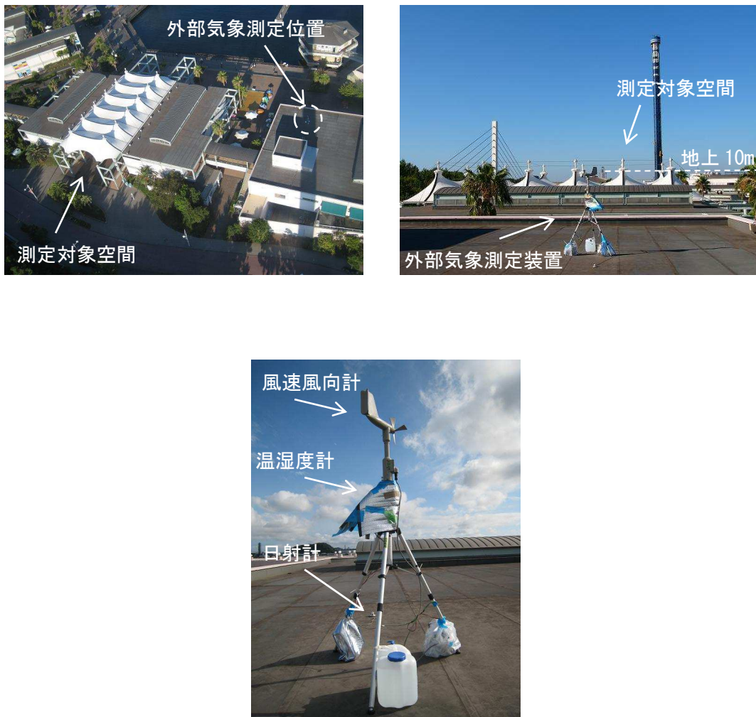
図 2-10 外部気象測定位置と測定機器
