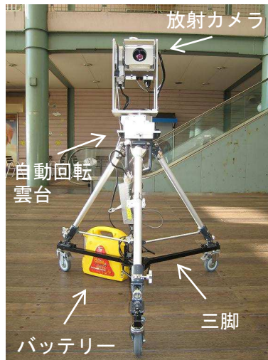
図 2-15 全球熱画像収録システムの外観
