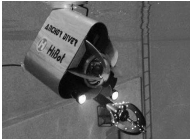
図5 ワイヤ牽引型水中探査ロボット Anchor Diver IV
