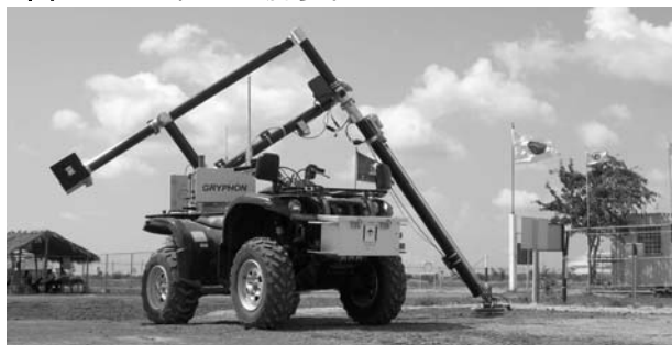
図4 人道的地雷探査ロボット Gryphon
