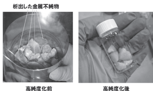
図2 還元性ガス吹き込みによる高純度化した溶融塩 Flibe（東京大学で実施）。
