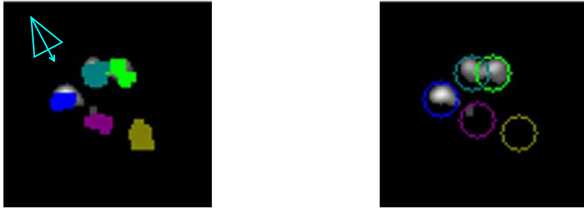
図 4.13: 5人の人物のデータセット D_5 で平面図上の領域分割を行った例（左）と，比較のために固定サイズの円形ウィンドウを当てはめて描画した例（右）．円形ウィンドウのサイズは Occupancy を含む必要最小限の大きさに設定したが，人物が近接している場合はウィンドウが重複する．なお，右下の人物の Occupancy Map が得られていないのは，当該 Occupancy Map が図に示すカメラ視点から作成されたもので，隠蔽による為である．
