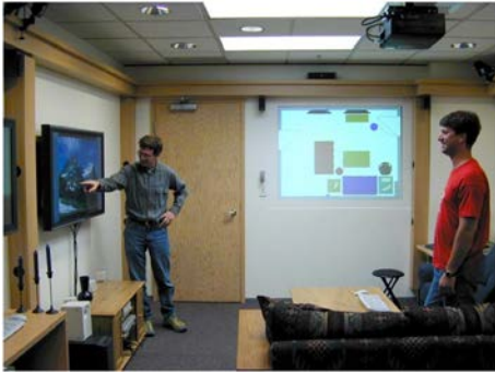
図 2.1: 2 視点を利用する人物追跡システム (Krumm ら [28] から引用). 図中では奥行き情報と色情情報を使って検出した 2 人の人物を, 平面図に赤色と青色の円で表して, プロジェクタで表示している.
