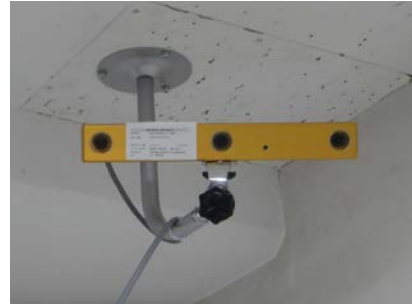
図 3.4: 天井に取り付けられたステレオカメラ
