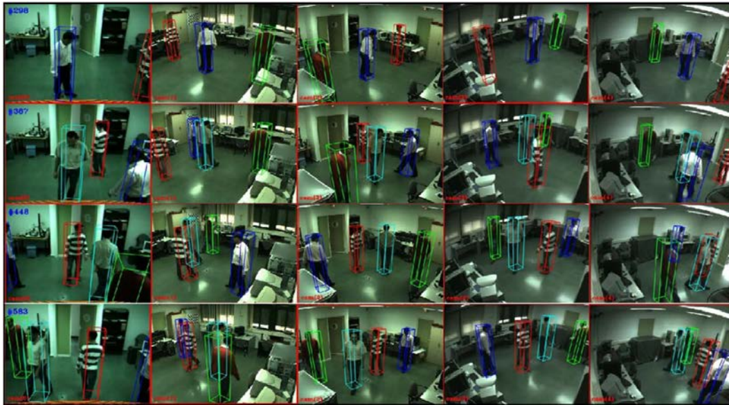
図 2.3: 天井に設置された 5 台のカメラを利用する人物追跡システム (Salinas ら [36] から引用). 単独視点画像上でパーティクルフィルタを使って特徴抽出した後, 全ての視点の情報を統合して追跡が行われる手法を提案し, 図のように隠蔽の頻発する混雑環境下でも追跡を可能にした.
