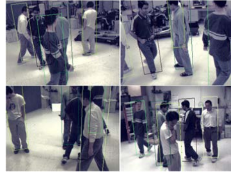
図 2.2: 最大 16 台のカメラを利用する人物追跡システム (Mittal ら [30] から引用). 単独視点画像上で前景の領域分割のみを行い, 全ての視点の結果を統合して追跡を行う.
