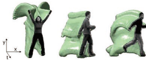
図 2.12: 人物のシルエットを時系列で並べて得られる 3 次元形状を基にしてジェスチャ認識を行う手法 (Blank ら [5] より引用)
