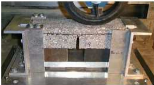
図-2.4.65 リフレクションクラック模擬試験状況 59)
