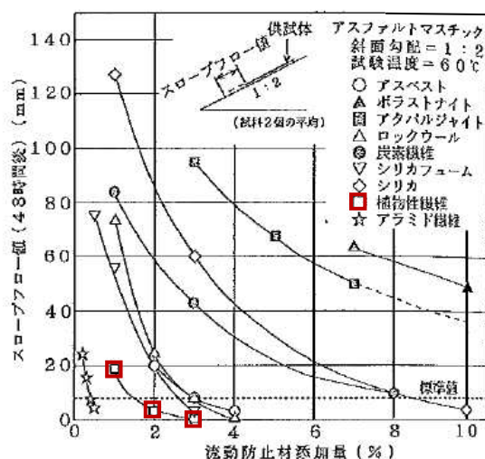
図-6.1.4 流動防止材添加量とスローフロー値の関係(文献16)に一部加筆)
