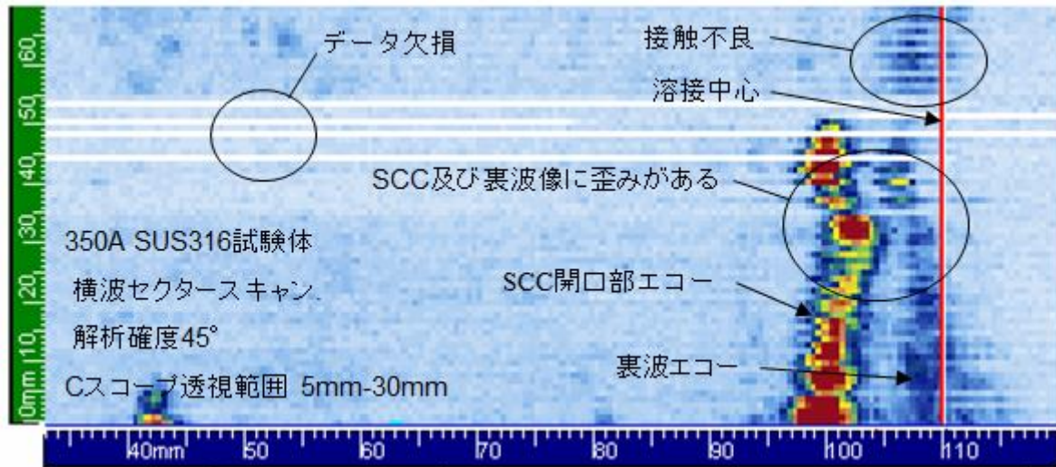
(b) データが不良である例 (Cスコープ)
