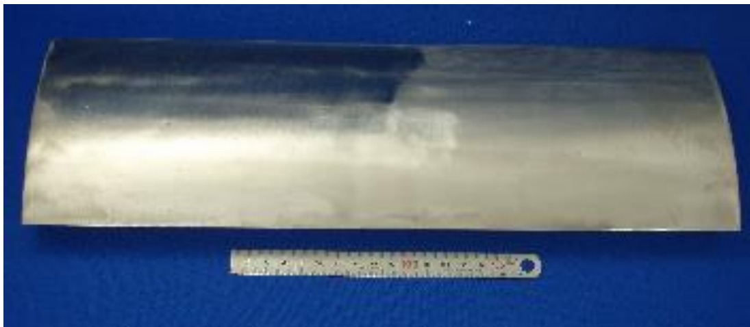
図 3-16 SCC 付 350A 試験体の外観写真
