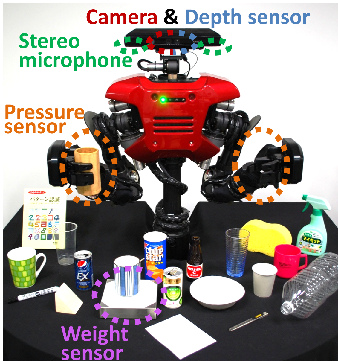
Figure 3.3: 使用したロボットや，センサ，物体の外観
