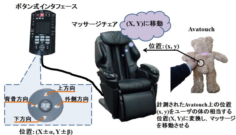
図 3.3:本マッサージチェアシステムの概要
