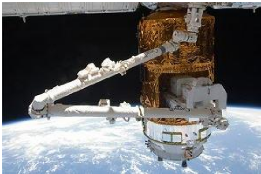
Figure 1-6 「カナダアーム 2 (Space Station Remote Manipulator、SSRMS)」 ．国際宇宙ステーションでの船外作業に使用される．[6] ©NASA/JAXA
