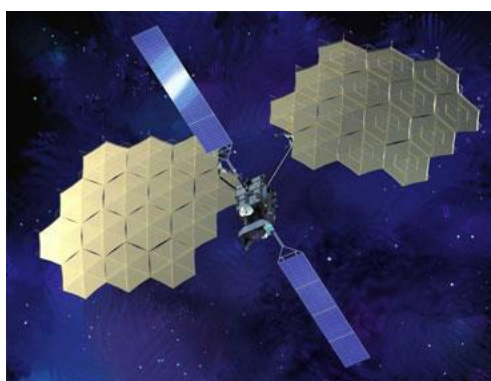
Figure 1-5 技術試験衛星「きく 8 号(Engineering Test Satellite-VIII, ETS-VIII)」．柔軟構造物を適用することによって実現した大面積のアンテナが特徴である．また大電力を確保するために大型の展開パドルを搭載する[5]©JAXA
